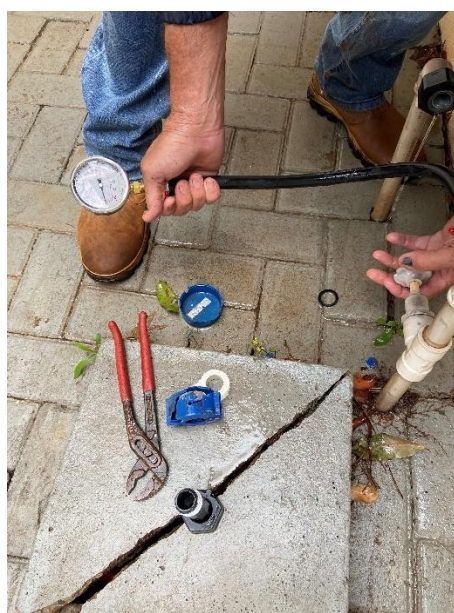
Foto 78: Ponto 01 – Ano de fabricação 2017. Foto 79: Pressão ponto 01 = 28 mca
