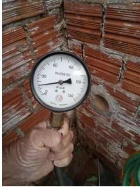
Foto 79 – Hidrômetro P02 – P = 15.00 mca
