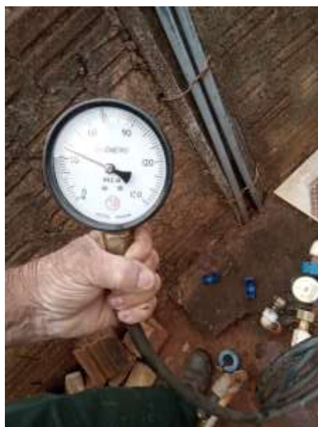
Foto 85 – Hidrômetro P03 – P = 36.00 mca
