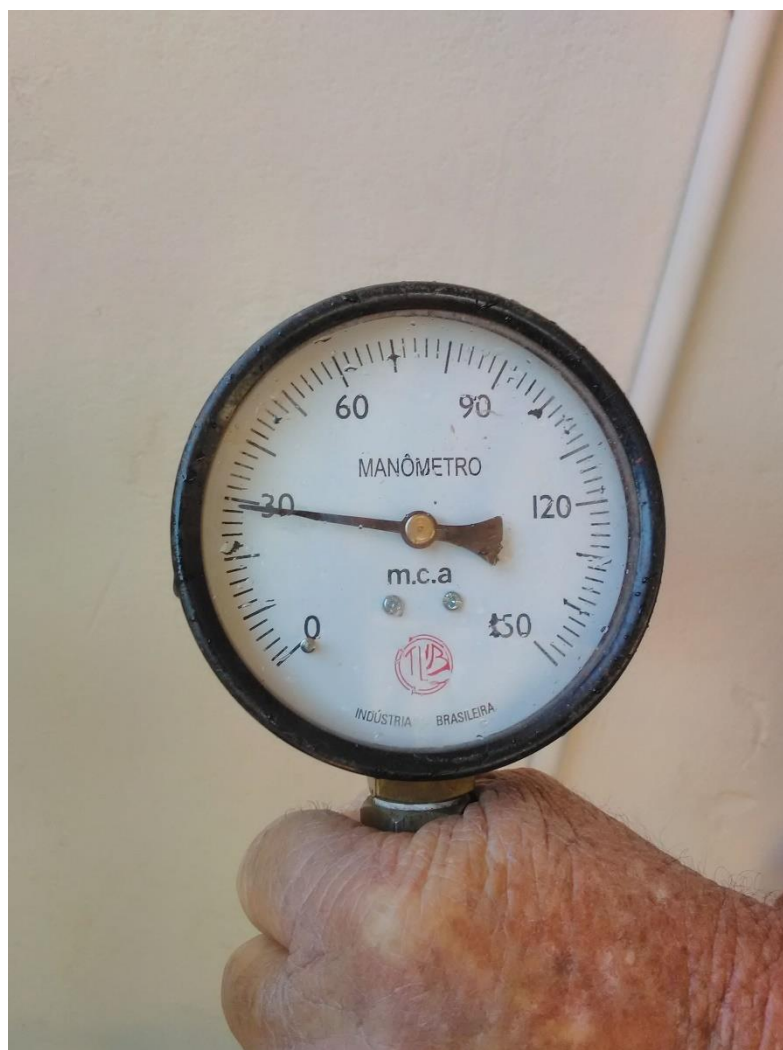
Foto 103 – Medição pressão na rede Rua Antonio Pegussi nº. 6 ((Latitude: -22.721043°, Longitude: -52.610949°) – P = 30 mca
