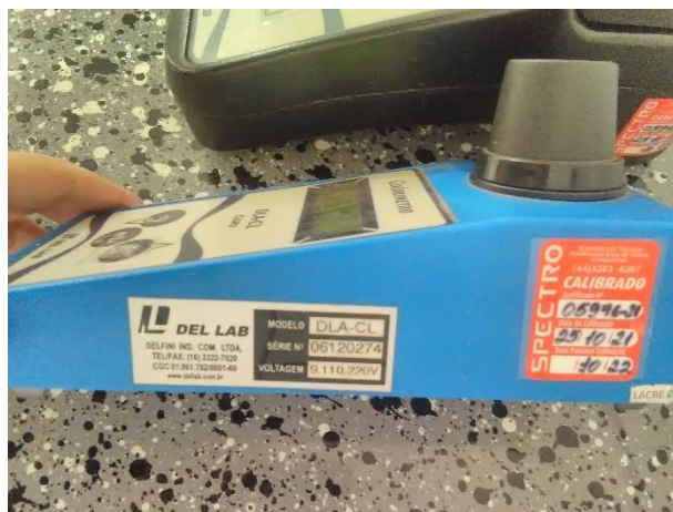
Foto 111 – Calibração do colorímetro realizado em 25/10/2021
