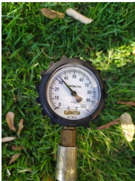
Foto 55 – Hidrômetro P02 – P = 33,50 mca
