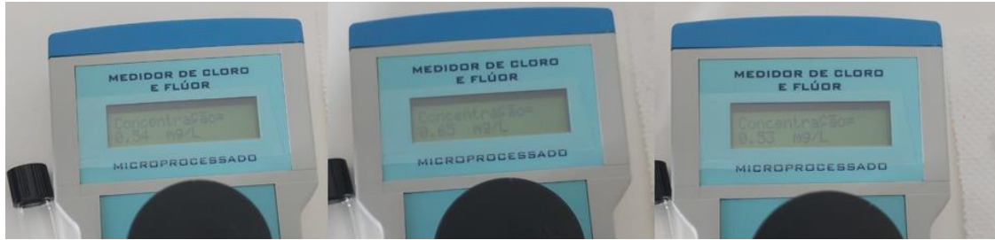
Foto 75 - Medição de cloro do P03
