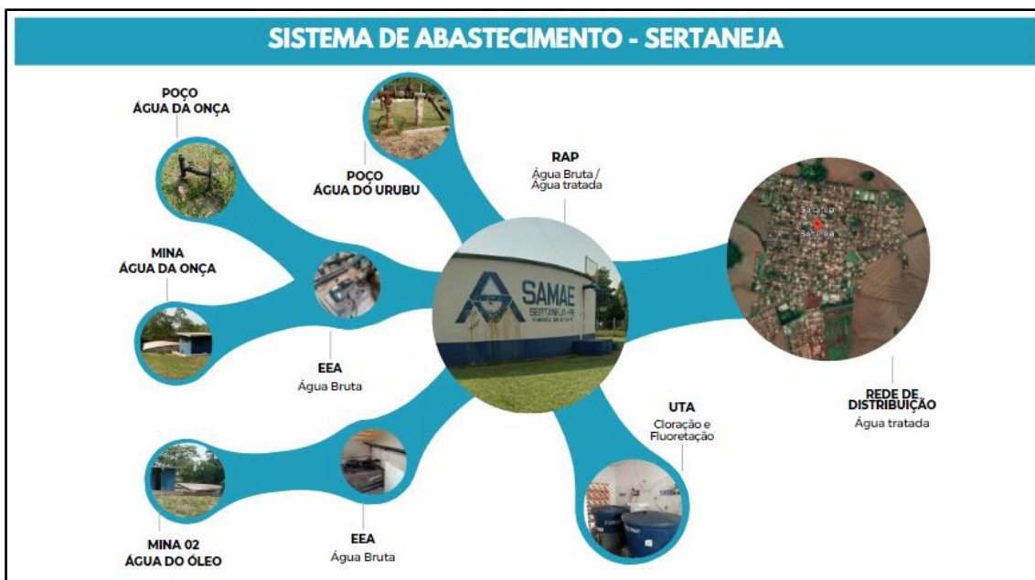
Figura 1 - Fluxograma do Sistema de Abastecimento de Água
