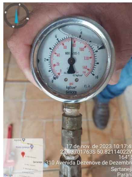
Foto 72 - Medição de pressão do ponto 03
