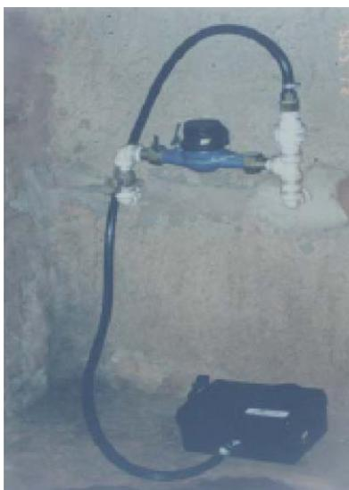
Figura 10 – Conjunto de medição contínua formado por manômetro digital e data logger.
